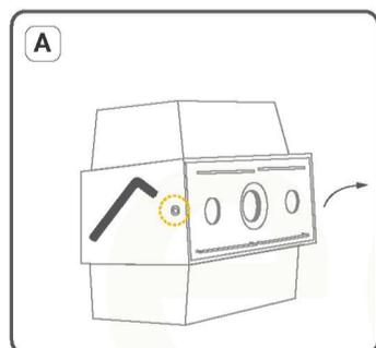
Retire los tornillos de la parte trasera para desmontar la base de la luminaria.
